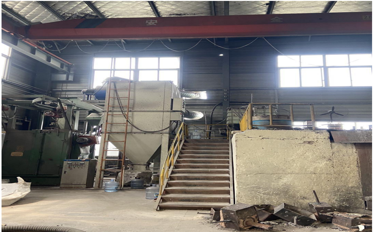
图 3.2-3 熔炼工序脉冲式布袋除尘器
