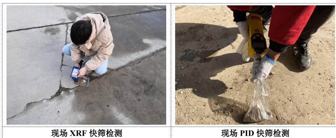
图 7.2-1 现场快速检测
