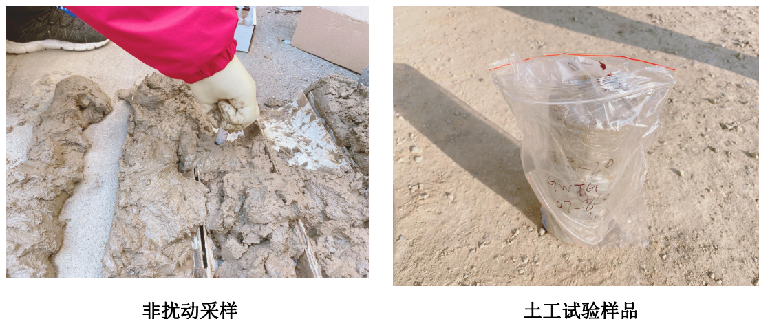
图 7.2-2 非扰动采样器及土工试验取土器
