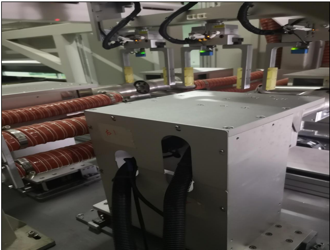
模组（自动线）点胶废气收集设施
